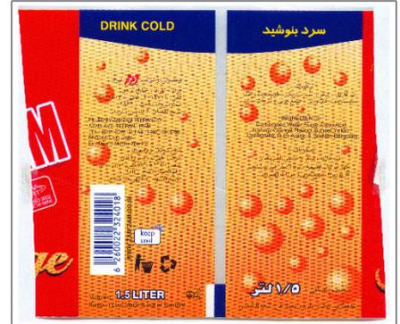
Рис. 93: Более одного цвета в зоне сканирования до и после метки отрезания и минимальный размер зоны сканирования не учтены.
