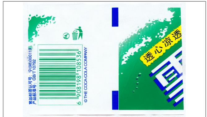
Рис. 95: Более одного цвета в зоне сканирования до и после метки отрезания
