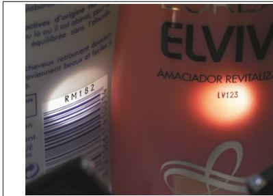
Рис. 14: Нанесение датирования горячим тиснением
