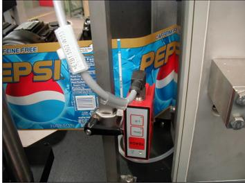
Рис. 73: Сканирование метки отрезания сенсорным датчиком
