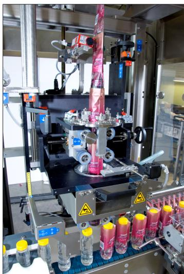
Рис. 114: Пример сенсорного сканирования метки отрезания
