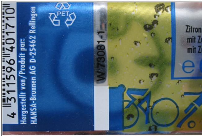
Рис. 83: Пример для метки отрезания на нижнем крае этикетки
