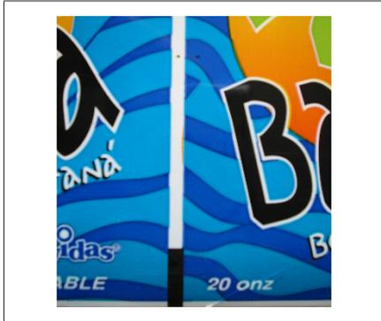
Рис. 91: Более одного цвета в зоне сканирования до и после метки отрезания и недостаточный цветовой контраст
